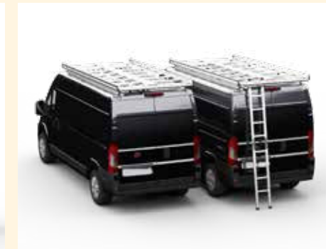
Échelle escamotable sous galerie, avec charnière pour H2 et H3 afin d'en faciliter l'extraction. Peinture noire en option
